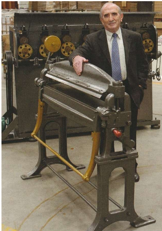
Máquina para la fabricación de tubo cilíndrico y plegadora herramientas decisivas en los inicios de Manufacturas Metálicas Jevit.
